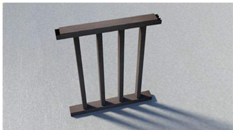
Готовая конструкция вставляется под перила. В их профиле снизу имеется паз, в который заходит верхний брус секции. Нижний брус крепится к столбам ограждения при помощи металлических уголков. Таким образом, единственными жесткими точками крепления секции находятся внизу, сверху она удерживается пазом в перилах, а балясины стоят враспор, их поперечное смещение предотвращают крепления на брусе.
